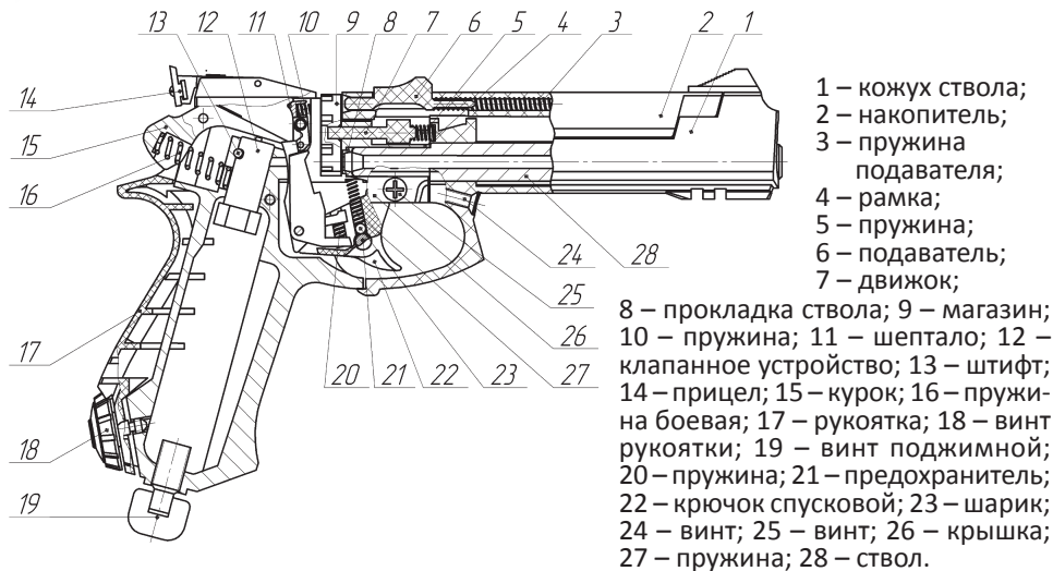
Рисунок А.2 – Схема механизмов pistols MP-651K, MP-651K
