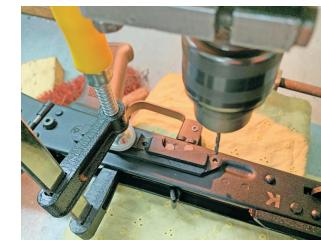
4. Используя планку в качестве кондуктора, аккуратно просверлить два отверстия Ø 3,3 мм, не нарушая резьбу M4 в отверстиях планки.
