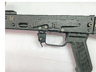
6. Установить планку на ствольную коробку с помощью винтов M4x6 и M4x8 соответственно.
