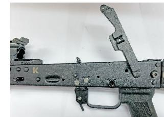
5. Сняв струбцину и отведя планку, рассверлить отверстия до Ø 4,0 мм.
