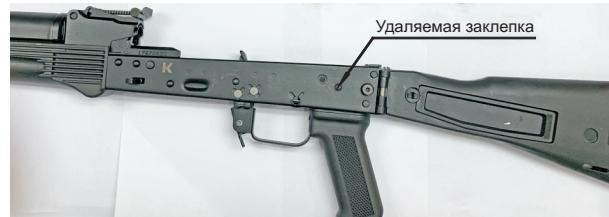
3. Закрепить планку на оружии с помощью винта M4x8 через отверстие с удаленной заклепкой. Все винты для крепления планки вворачивать с внутренней стороны ствольной коробки.
